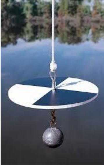
Figura 2. Disco de Secchi para medir la turbidez del agua.
